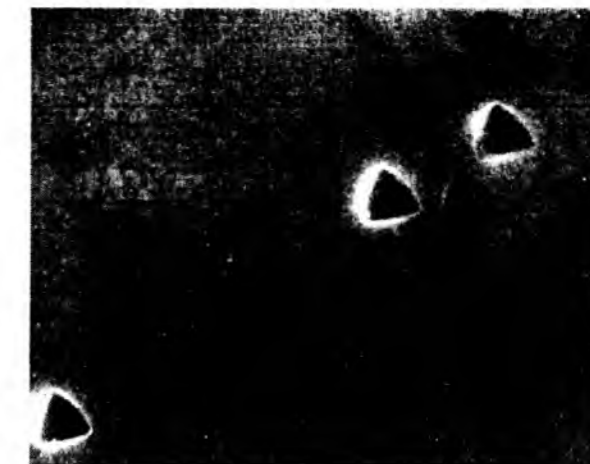
Рис. 3. Типова електронна картина б'б' дислокацій на поверхні пластини кремнію КЕФ 4,5 (111), отримана після обробки виборчим хімічним травником Сиртля протягом 2 хвилин.
