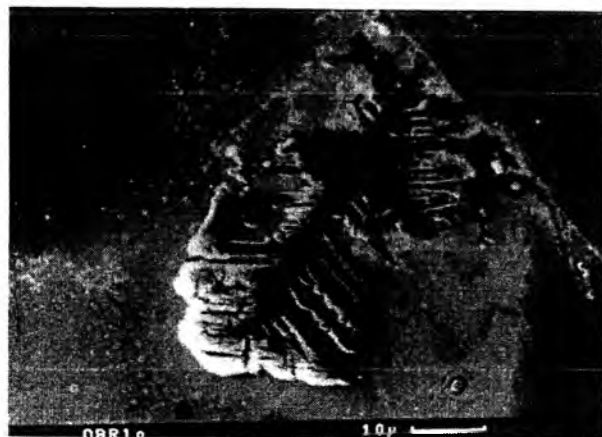
Рис. 6. Електронне зображення дендритів на поверхні пластини кремнію КДБ 10 (100) (а) і КЕФ 4,5 (111) (б) (x 2300).
