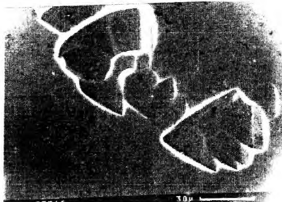
Рис. 5. Електронне зображення скупчення дислокацій на поверхні пластини кремнію КЕФ 4,5 (111), отримане після обробки виборчим травником Сиртля протягом 2 хвилин.
